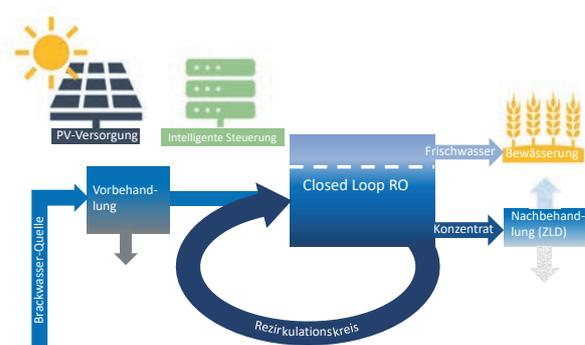
Schema der in HighRec weiterentwickelten Umkehrosmose im geschlossenen Kreislauf
