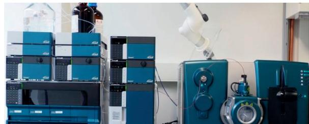
Die Forschenden im Projekt iMolch nutzen unter anderem ein Massenspektrometer, um kleinste Verunreinigungen im Bereich von Nanogramm pro Liter (ng/L) im Grundwasser nachzuweisen.
