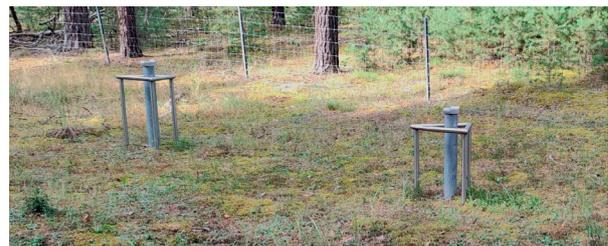
An Grundwassermessstellen werden regelmäßig der Grundwasserstand und die Qualität des Grundwassers bestimmt.
