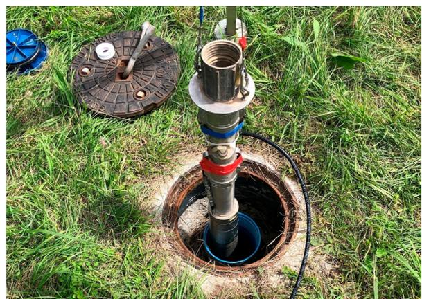
Eine Grundwassermessstelle; das Grundwasser wird an die Oberfläche gepumpt, um Proben abzufüllen.
