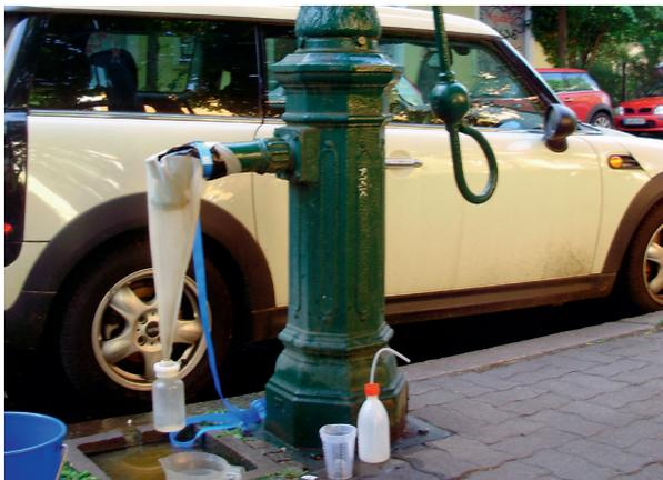
Grundwasserprobennahme an einer für Berlin typischen Schwengelpumpe. Für die Umweltkommunikation werden diese Probennahmen in Maßnahmen der Öffentlichkeitsarbeit eingebunden.
