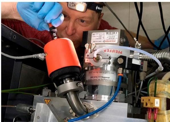
Wasserisotope können mit einem Massenspektrometer gemessen werden. Das Bild zeigt die Wartung des Geräts.
