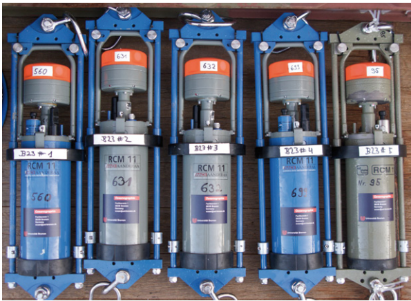
Doppler Current Meter RCM 11 für Tiefseemessungen bis zu 6.000 Meter
