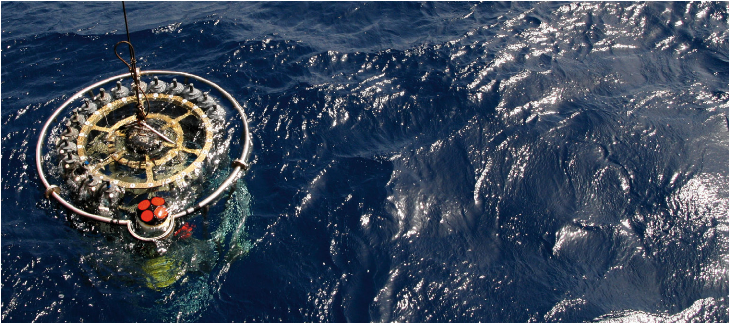
CTD-Messgerät für Messungen des Salzgehaltes, der Temperatur und der Tiefe
